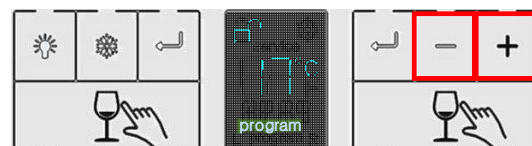
Abb. 3: Einstellen der Temperatur
