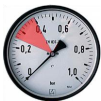
Abb. 5 Manometer mit Skala für den Abgabe- bzw. Betriebsdruck (0,25-0,4 bar)
